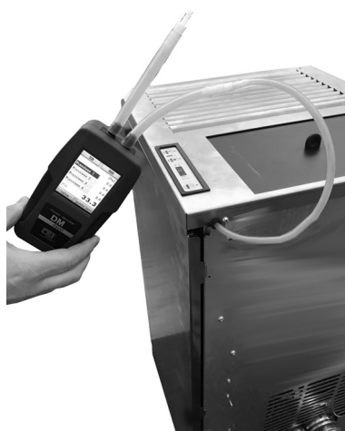
Fig. 63 - Conexión del presostato digital
