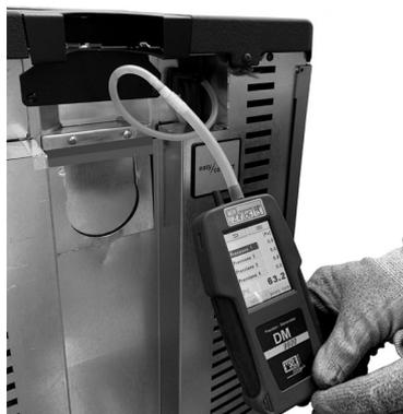
*Fig. 64 - Conexión del presostato digital*
