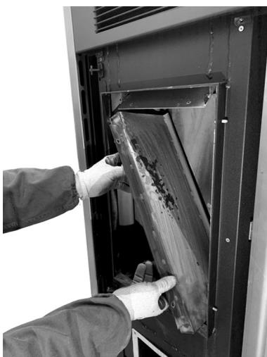
**Fig. 74 - Retire las paredes laterales**
