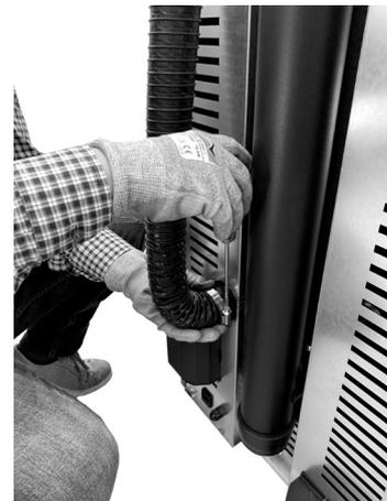
**Fig. 48 - Acople el tubo de aire comburente**
