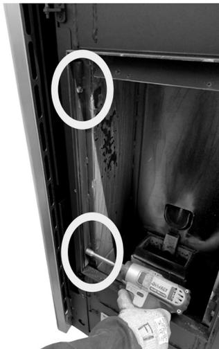
**Fig. 71 - Extraiga los tornillos hexagonales**
