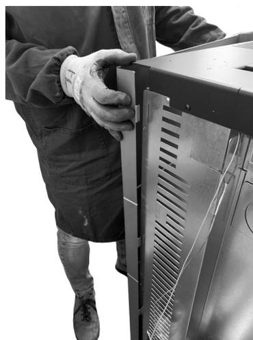
*Fig. 30 - Retire las paredes laterales*
