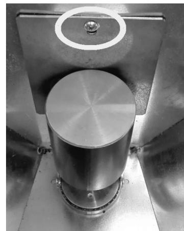
**Fig. 85 - Retirada del tornillo**
