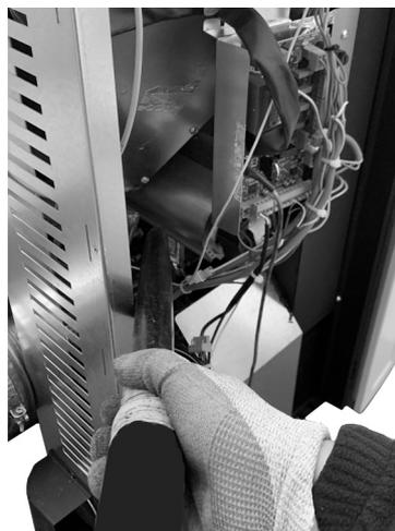
*Fig. 82 - Limpieza ventilador ambiente*
