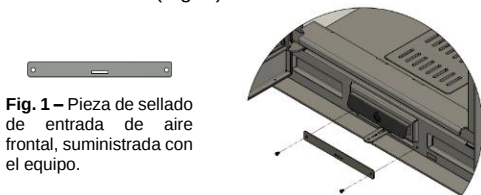
Fig. 2 – Retire los tornillos; coloque la pieza de sellado y vuelva a apretar los tornillos.
