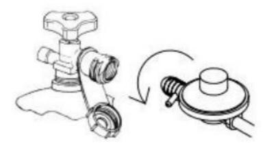
1. Conecte la manguera al aparato y al regulador. Apriete el tornillo de la abrazadera de la manguera con un destornillador.
