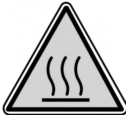
Fig. 1 - ATENCIÓN. SUPERFICIE CALIENTE
