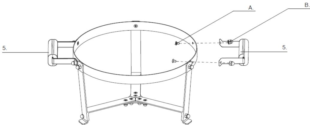
**PASO 3** - Ahora conecte los tiradores (5) al anillo (1) utilizando los tornillos y las tuercas de la tapa.
