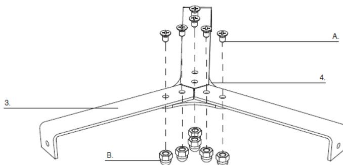
**PASO 1** - Sujete los 3 soportes (3) y la pieza de conexión triangular (4) con 6 tornillos (A) junto con 6 tuercas de tapa (B).
