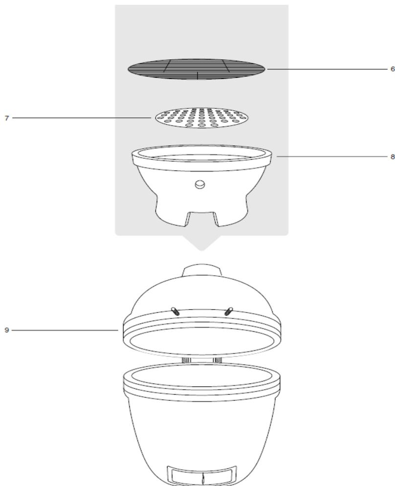
**PASO 5** - Una vez que la parrilla esté bien colocada en la base, coloque la bandeja de fuego (8), la placa de carbón (7) y la rejilla de la parrilla (6) en la parrilla Kamado como se muestra en el diagrama de montaje.
