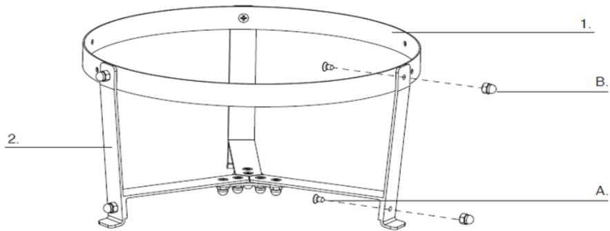
**PASO 2** - Sujetar los 3 montantes (2) al anillo (1) con 3 tornillos (A) y 3 tuercas de tapa (B). A continuación, fije la cruz del paso 1 a los montantes con 3 tornillos (A) y 3 tuercas de tapa (B).
