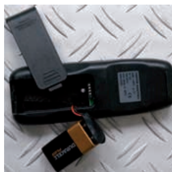
Vervangen van de batterij in de afstandsbediening
