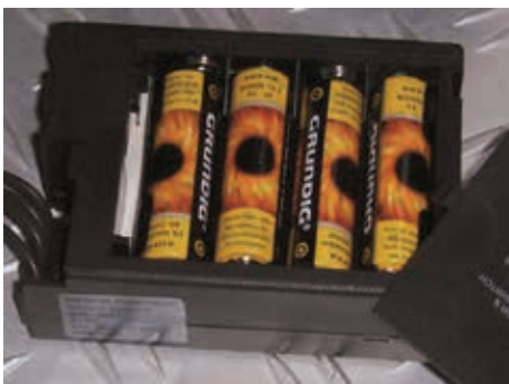
Remplacement des piles du récepteur
