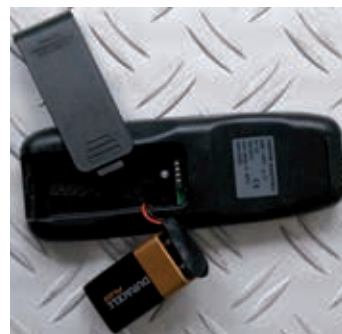
Remplacement du bloc-piles de la télécommande
