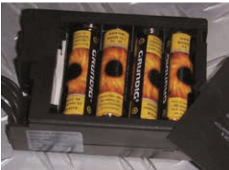
Auswechseln der Batterien im Empfänger
