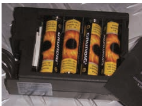
Vervangen van de batterijen van de ontvanger
