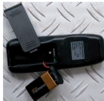
Auswechseln der Batterien in der Fernbedienung
