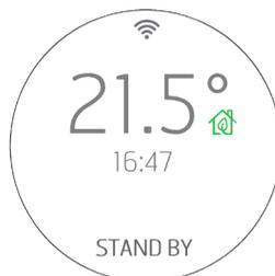
Cuando la temperatura ambiente alcanza la temperatura programada y todos los parámetros también se respetan (ver apartado siguiente), el equipo se apaga y la pantalla muestra la temperatura ambiente, la hora actual e indica STANDBY, que significa que se encuentra en un estado de espera que permite que se vuelva a encender el producto en cuanto la temperatura desciende por debajo del umbral programado o permite ver si sube la temperatura deseada en el ambiente.
