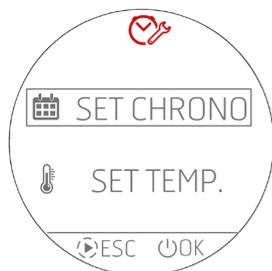
Para configurar las temperaturas de SET T1 – T2 – T3 – T4 (T3 y T4 solo para estufas Hydro), hay que entrar en el menú **SET TEMP.** seleccionando la entrada con las teclas  $\oplus$   $\ominus$  y confirmando con la tecla  $\odot$  OK.
