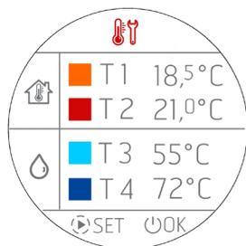
Presionando la tecla  $\odot$  SET, la primera temperatura (T1) pasa a colorearse de ROJO y con las teclas  $\oplus$   $\ominus$  se puede proceder a la modificación con pasos de 0,5°C. Con una presión prolongada de las teclas  $\oplus$   $\ominus$  se tienen variaciones de temperatura a pasos más elevados, siguiendo la misma filosofía de las modificaciones de las temperaturas en el panel.
