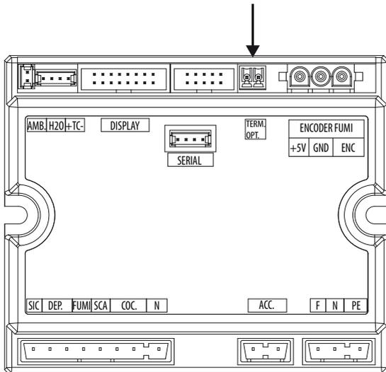
La temperatura de la estufa también puede ser controlada por un termostato de ambiente exterior. Debe colocarse en una posición intermedia con respecto al local de instalación para garantizar una mayor correspondencia entre la temperatura de calefacción demandada a la estufa y la temperatura suministrada efectivamente por la misma.
