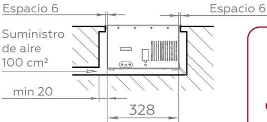
**¡Advertencia!** ¡Para el correcto funcionamiento de la chimenea inteligente, se debe instalarlo exactamente en horizontal! ¡Use un nivel!
