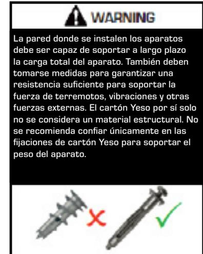
Compruebe periódicamente la seguridad de las fijaciones a la pared. Compruebe también la seguridad del cable de alimentación y de las conexiones. Si el cable de alimentación se daña, debe ser sustituido por un agente de servicio o persona competente, como un electricista cualificado.
