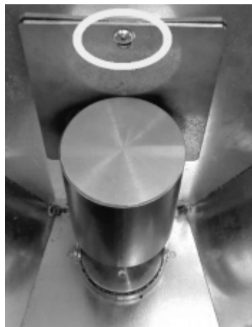
Fig. 65 - Retirada del tornillo
