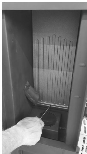
Fig. 57 - Retire la parte trasera del hogar 1
