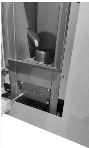
Fig. 61 - Retire la tapa
