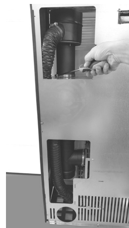
Fig. 37 - Bloqueo con abrazadera
