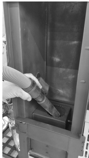
Fig. 49 - Aspire las cenizas
