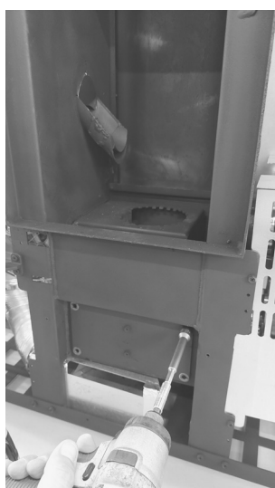
Fig. 52 - Retire la tapa
