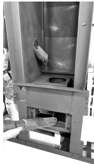
Fig. 60 - Aspire las cenizas
