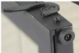
12- Sistema de cierre de seguridad. Un ingenioso y patentado sistema de cierre permite la fácil apertura lateral para el mantenimiento de las puertas de guillotina. Una vez accionado el cierre, la puerta queda cerrada de forma totalmente hermética y segura.
